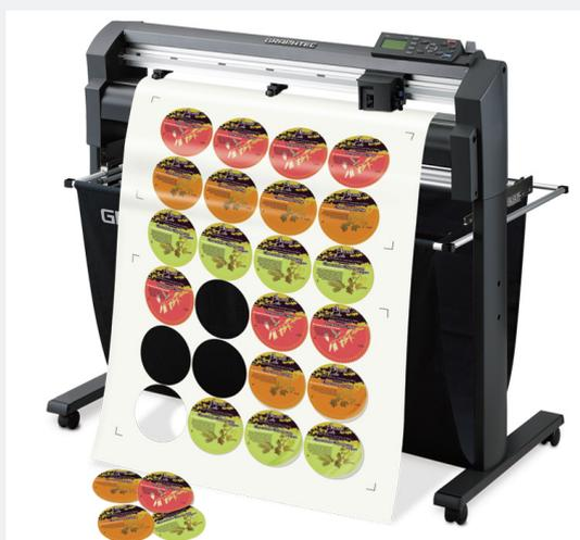
Рис. 11. Режущий плоттер в работе - этикетки
