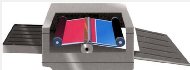
Рис. 2. Схема сублимационного принтера
