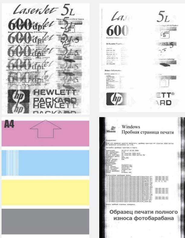
Рис. 1. Образцы технических дефектов цифровой печати
